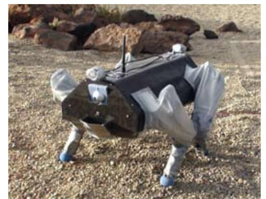
Die Federn des a.l.f. (autonomer Laufroboter mit Federn) sind durch Manschetten gegen den Staub geschützt. (Bilder zVg)
