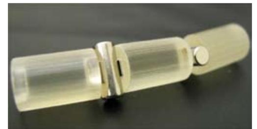
Modell für einen selbstorganisierten Magenroboter: Drei Module werden mit Hilfe eines magnetischen Mechanismus über Zwischenglieder verbunden. (Bild zVg)
